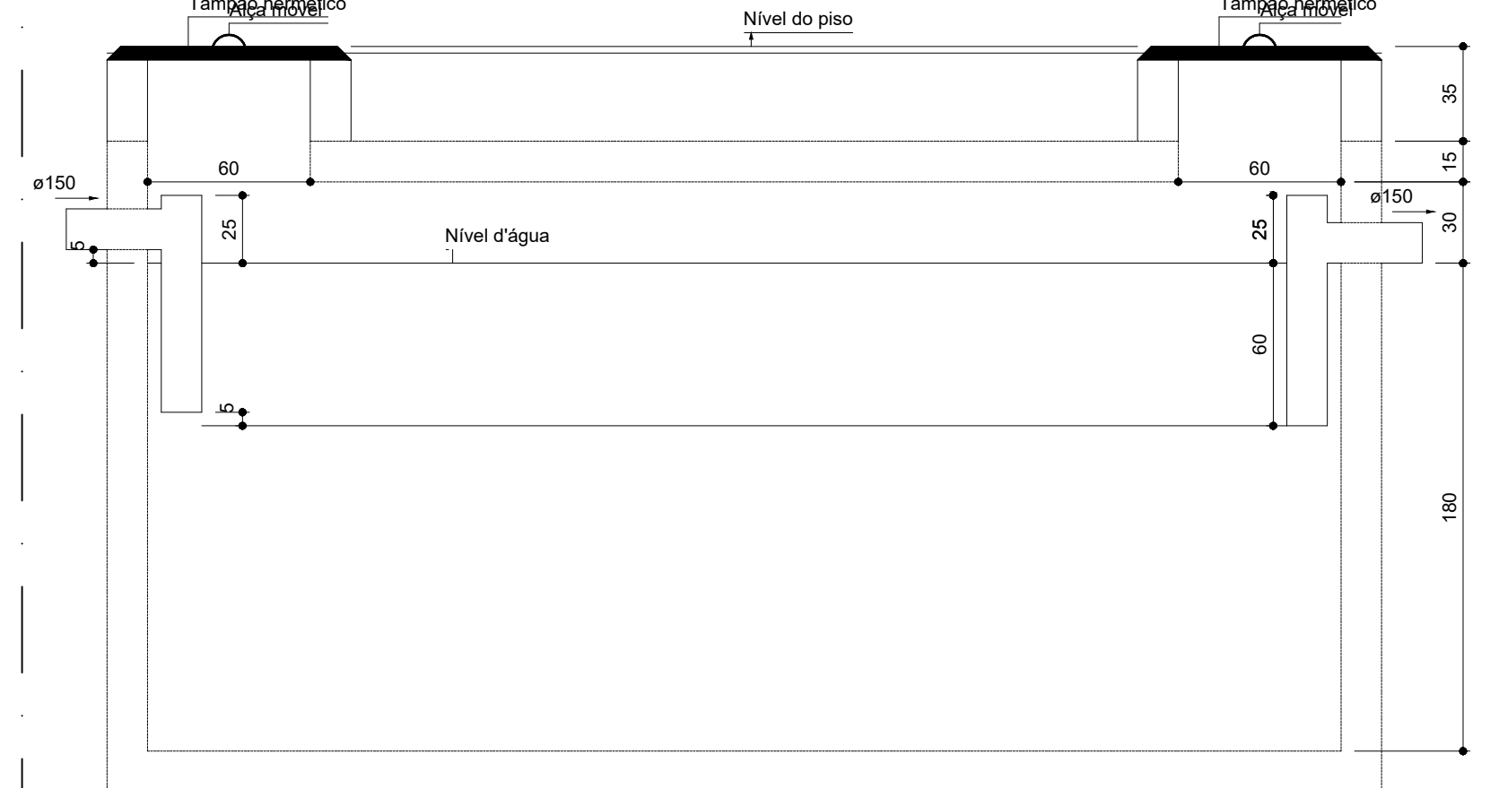
Tanque séptico Corte 1
